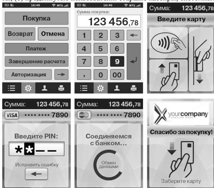
Рис.4. Пример дизайна ПИ для платёжного терминала: ввод стоимости покупки продавцом и действия покупателя по оплате покупки
