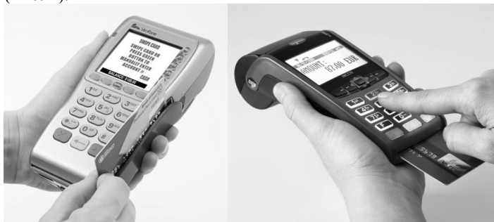
Рис.1 . «Обычные» беспроводные платёжные терминалы
